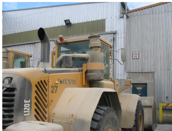
Slika 2: Pravilna postavitev filtra – TAKO NAJ BO POSTAVLJEN
